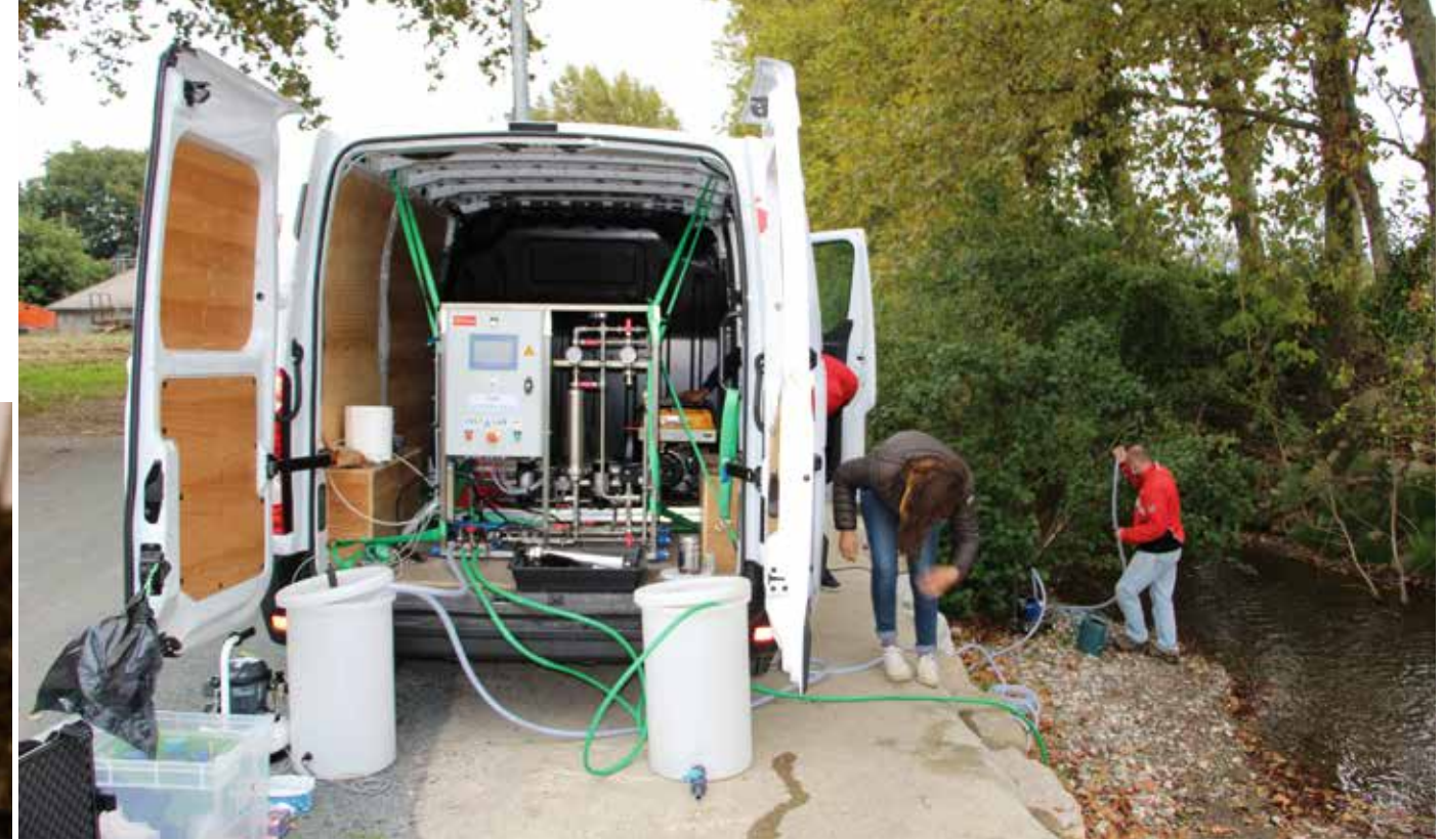
Dans ce camion, un appareil prototype de dépollution de l'eau, en aval de la mine de Salsigne. L'arsenic présent dans le ruisseau est filtré par des poudres racinaires de plantes aquatiques. En 2021, dans l'Aude.
